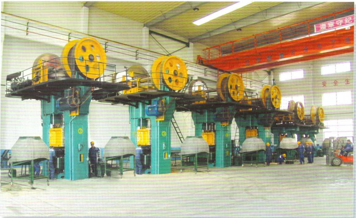
J93G-1000吨磨擦压力机 1000T Friction Press J93G-630吨磨擦压力机 630T Friction Press
