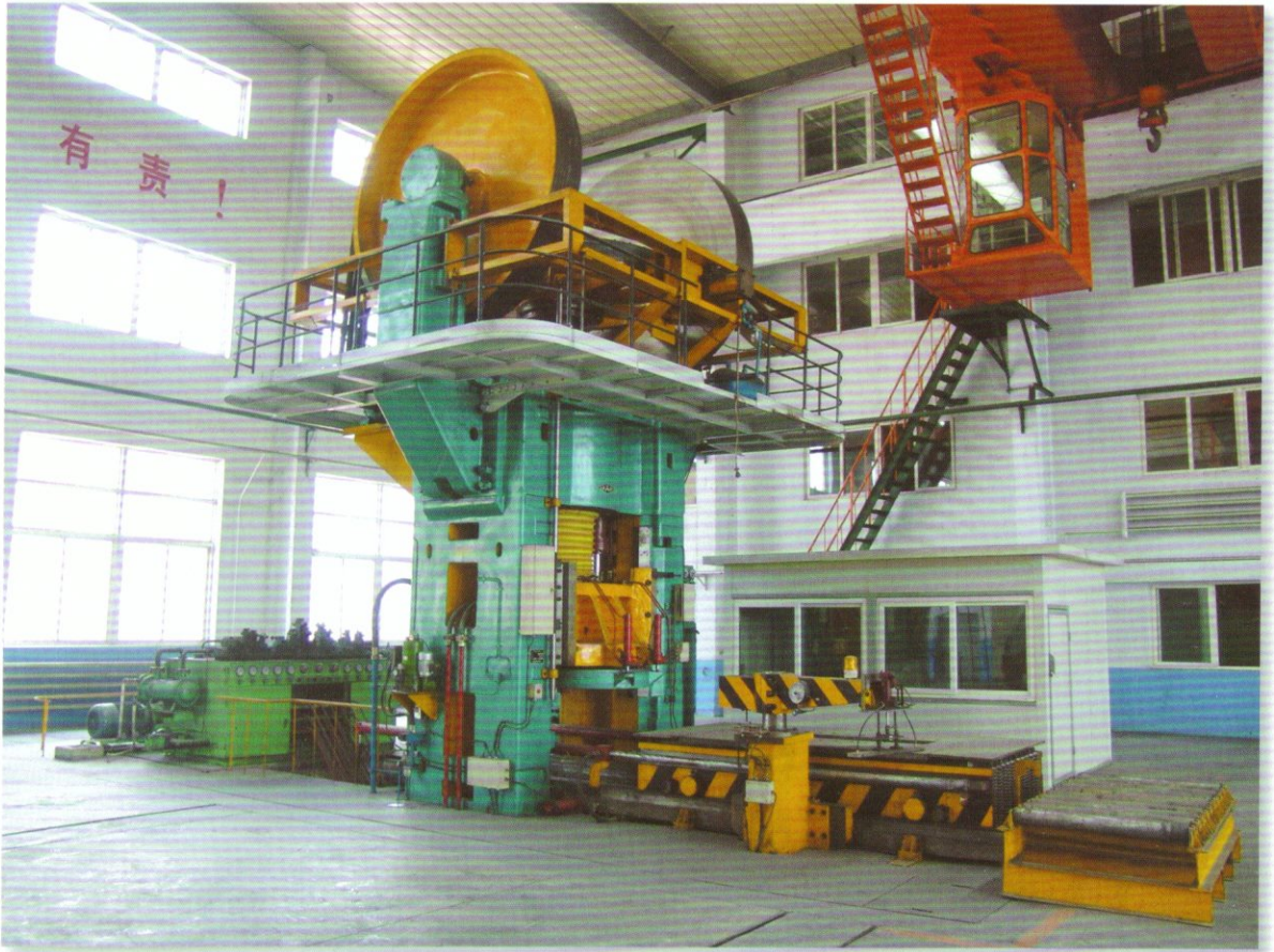
JA69-1600复合式压砖机 1600T Vacuum Friction Press
